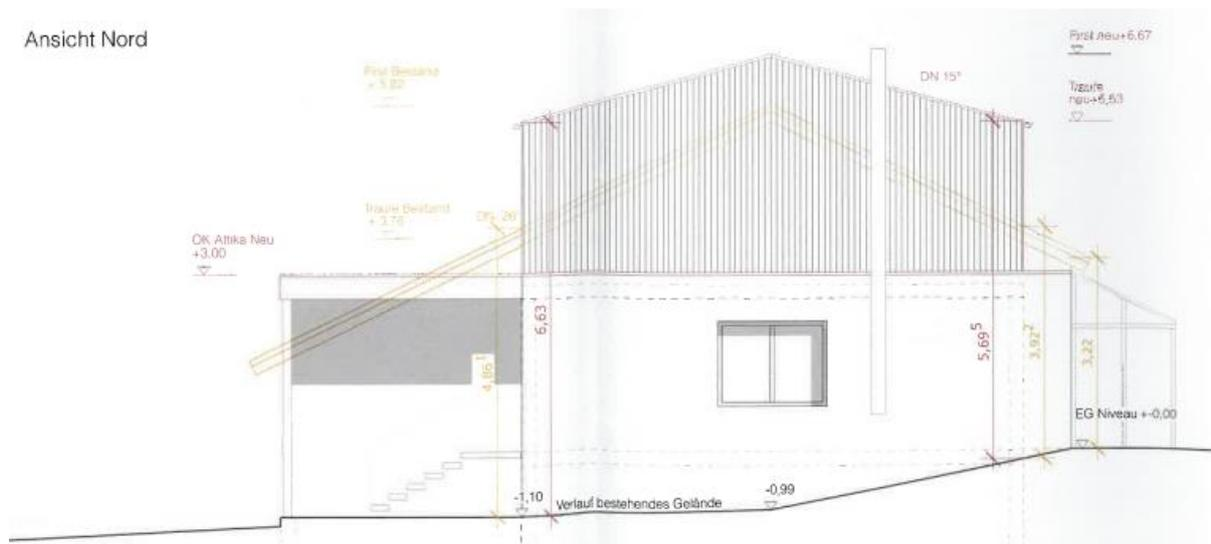
Überschritten ist die **Festsetzung einer maximalen Firsthöhe von 2,92 m**, die der Bebauungsplan festsetzt. Dies war bereits beim Bestand der Fall; die geplante Aufstockung führt zu einer **neuen Firsthöhe von 5,32m!**
